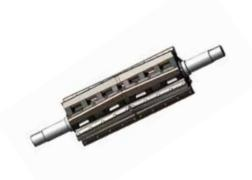
此刀辊叶片间的空隙较大,有利于快速吃料;刀爪较多,切削效率高,适合破碎橡胶等材质物料。
