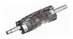
刀辊采用实心刀体结构,适合破碎极坚硬材质物料,如胶头料、厚壁管、厚板等物料。
