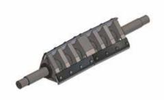
刀锟叶片间的间隙较大,能有效减少切削冲击力,适合破碎片材,薄膜等物料。
