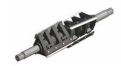
此刀辊采用多组错开一定角度的后置人字刀排布,减少切削冲击力,适合用于破碎薄壁物料,如PET瓶等。
